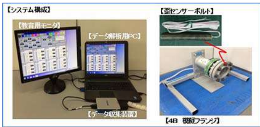
写真1 フランジボルトニングシミュレーター (D-BOLVIS: Daicel Bolting Visualization)
